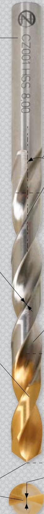
La geometria e l'angolo di elica della punta CZ001 creano condizioni ottimali per la formazione e l'evacuazione del truciolo includendo un buon passaggio di lubrificante.
